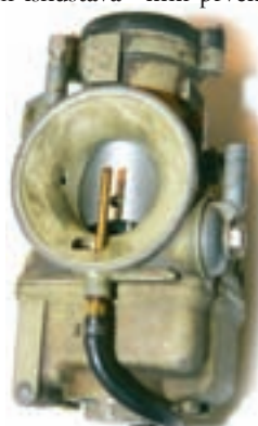
Karburator dellorto PHB-e promjer 32 s "Power jet" mlaznicom izrađen u magnezijevoj leguri. Plovcu su neovisni, a fiksiran je preko elastične gumene antivibracijske prirubnice
