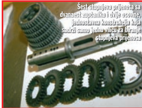
Sekundarni prijenos mjenjača. Zupčanici nanizani na šuplju izlaznu osovinu, kroz koju "putuje" svornjak, čime se fiksira zupčanik te tako ostvaruje željeni prijenos s primarnim snopom zupčanika
