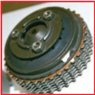
▲ Suha spojka sa nazubljenim lamelama. Potisna ploča je dijafragma (lisnata radijalna opruga), komanda je mehanička preko ručke, sajle i osovine koja oslobađa pritisak opruge i odvaja motor od mjenjača
