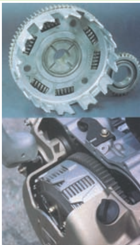
Ovih šest radijalno raspoređenih opruga u svrhu ublažavanja veze radilice - primar obično se nalazi na cross ili enduro izvedbama motocikala
