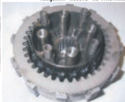
Ovih šest radijalno raspoređenih opruga u svrhu ublažavanja veze radilice - primar obično se nalazi na cross ili enduro izvedbama motocikala
