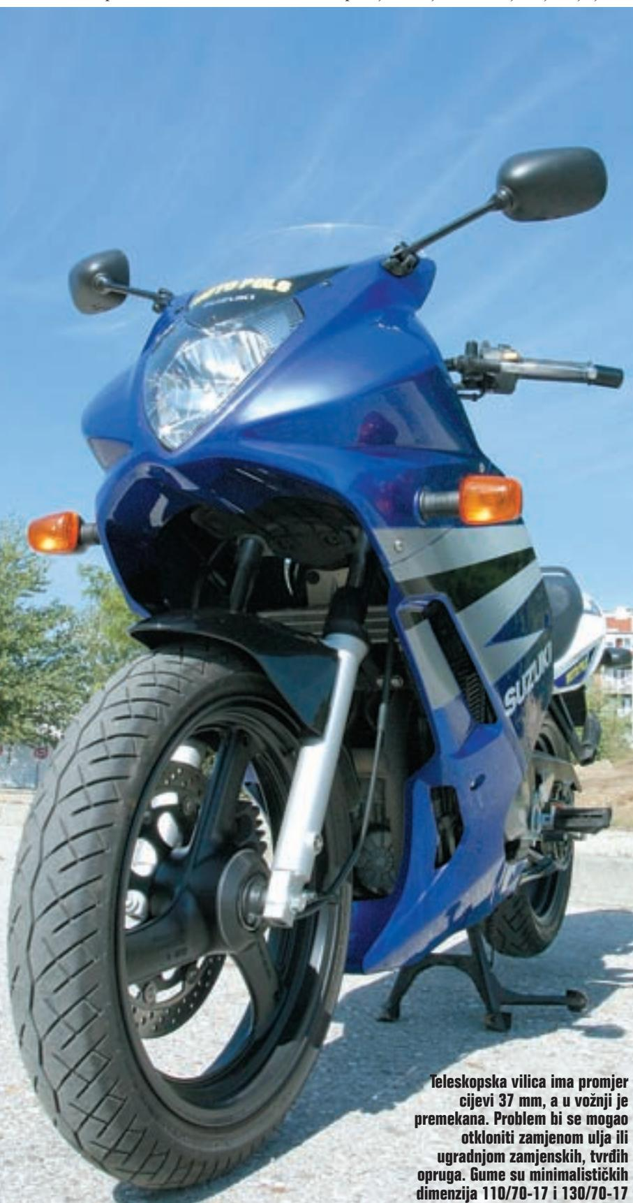
**Teleskopska vilica ima promjerci 37 mm, a u vožnji je premekana. Problem bi se mogao otkloniti zamjenom ulja ili ugradnjom zamjenskih, tvrdih opruga. Gume su minimalističkih dimenzija 110/70-17 i 130/70-17**
