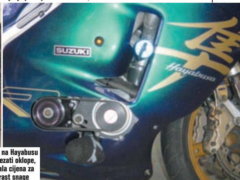
Roots kompresor i pojašnjenje principa rada
