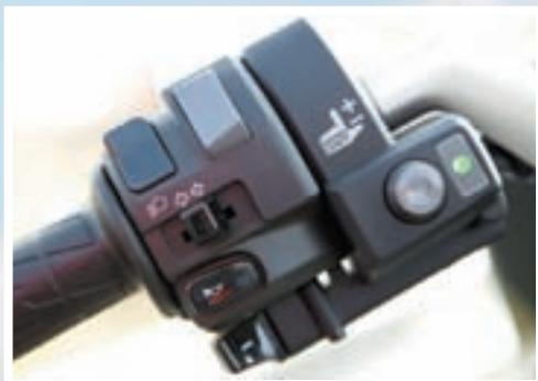
Obnovljeni kokpit obiluje opremom. Pomoću posebnih okruglih prekidača možete se igrati s visinom svjetlosnog snopa, kao i s intenzitetom rada električnih grijaca ručki, koji su dio serijske opreme kod modela AS.
