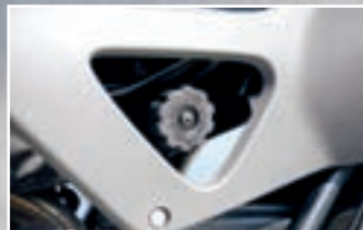
Varadero kao i ostali motocikli na testu ima podesivi stražnji ovjes.
