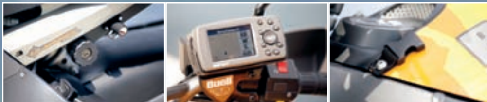
Stražnji ovjes podešava se pomoću vijka dok je testni model bio opremljen GPS uređajem.
