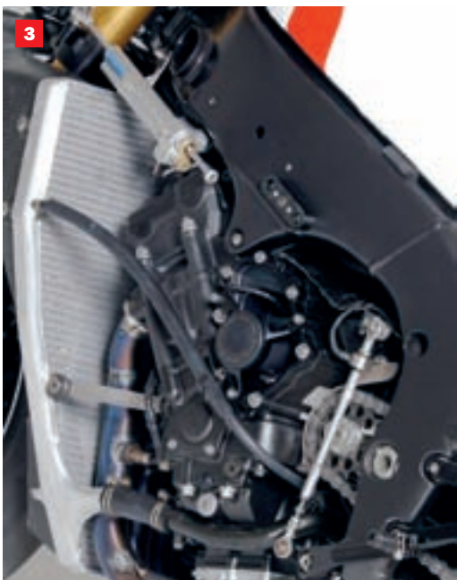
1. Prednja Ohlinsova TTX vilica i olakšani Machesini naplatci. Snažna kočiona klijesta tvrtke Brembo u kombinaciji s nazubljenim diskovima. 2. Stražnji Ohlinsov amortizer, mekši za ovu godinu, brine se za poboljšanje hvatljivosti stražnje gume. 3. Amortizer upravljača smješten ispod oplata
