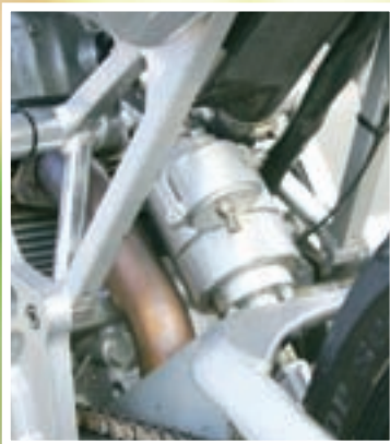
▲ Na stražnju aluminijsku vilicu također djeluje jednostruki zračni amortizer
