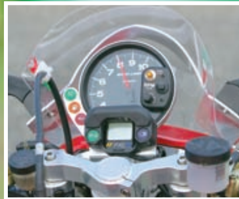
▲ "Spartanski" dizajnirana instrument ploča svojom izvedbom ne prati naglašeno futuristička rješenja cijelog motocikla. Iako analognog tipa, obrtomjer je velikih dimenzija i pregledan, za razliku od minijaturnog displeja na kojem je gotovo nemoguće očitati bilo kakav podatak
