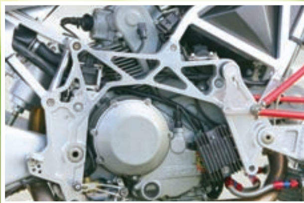
▲ Motor je Ducatijev 1000 DS, zračno hlađeni V-2 zapremine 992 ccm s jednom bregastom osovinom, dva ventila po cilindru i elektronskim sustavom napajanja goriva, koji razvija ukupnu snagu od 92 KS pri 8.000 okr/min i okretni moment od 9,4 kgm pri 6.300 okr/min. Za pistu, kojoj je Tesi namjenjen, je preslab
