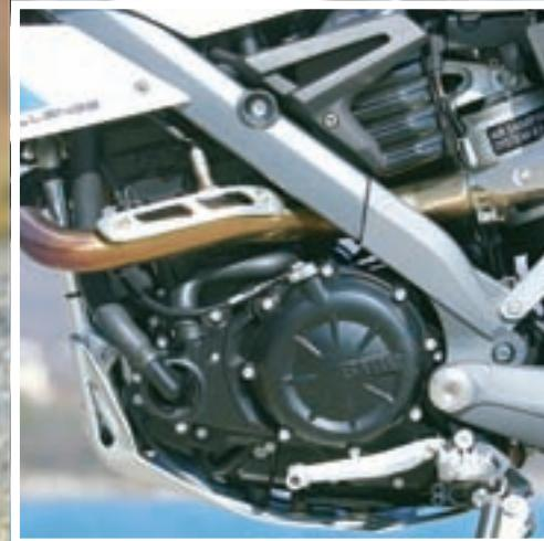
Pogonski agregat je jednocilinični Rotax preuzet sa prethodnog modela F 650 GS. Zahvaljujući suradnji između BMW-a i Aprilije veliki dio motora je redizajniran, a mnogobrojni dijelovi su modificirani kako bi se u novoj ulozi mogao pohvaliti dinamičnjim performansama i kompaktijom gradom
