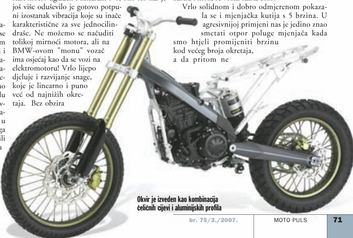
Okvir je izведен kao kombinacija čeličnih cijevi i aluminijskih profila
