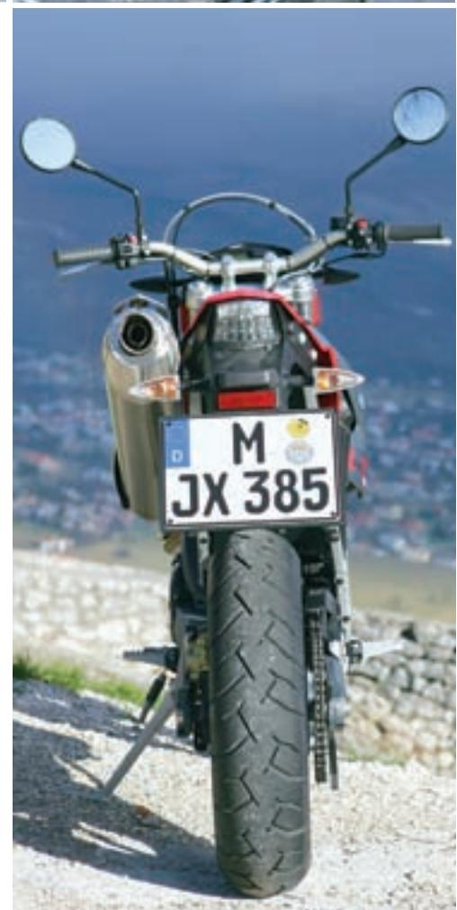
U skladu s orijentacijom klase motocikl se oslanja na atraktivne aluminijske kotače promjera 17", na koje su postavljene niskoprofile cestovne gume dimenzija 120/70-17 sprijeda i 160/60-17 straga
