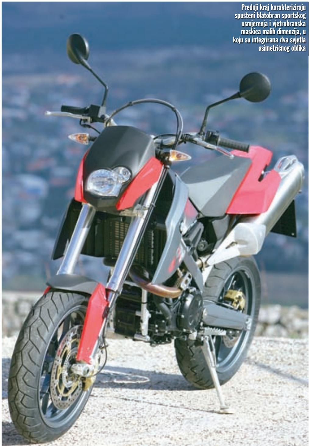
◀ Prednji disk promjera 320 mm na koji djeluju četveroklipna Brembo kočiona klješta.
