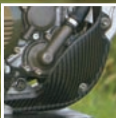
Dok se neki s prekomjernom težinom bore raznim kemijskim preparatima, ovdje vidimo drugo rješenje: radi uštede na težini štitiči agregata i mnogi drugi dijelovi izrađeni su od ugljičnih vlakana kao i stražnji dio okvira koji ujedno služi i kao kućište filtera zraka tvrtke TwinAir
