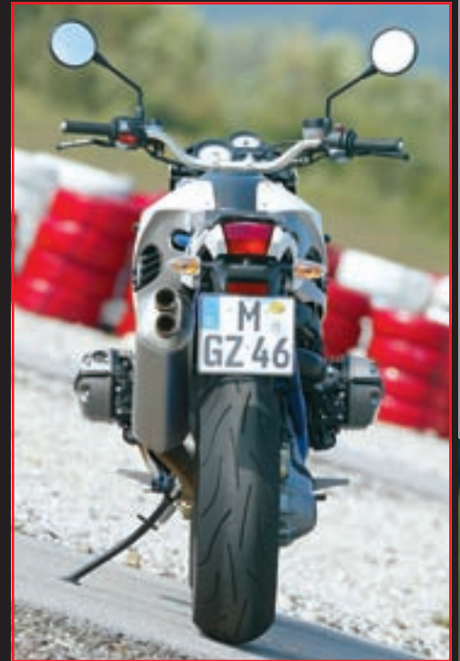
I gledano straga, svaki od ova tri motocikla je poseban. Dok su Ducati i KTM smjestili svoje ispušne sustave ispod sjedala, BMW se odlučio za klasično rješenje u kojemu je ispušni sustav sa strane
