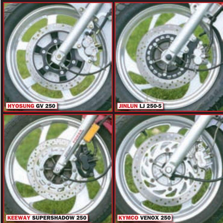
Diskovi različitih promjera različito dobro funkcioniraju. Tako Jinlun osjetno zaostaje za drugima, dok se Kymco izdiže iznad prosjeka. Keeway i Hyosung imaju zadovoljavajuće kočnice
