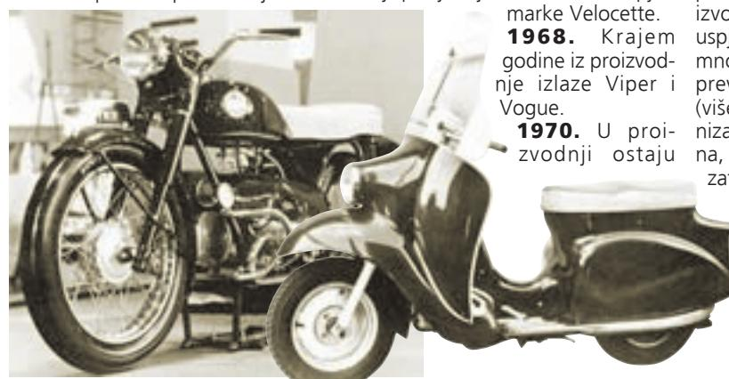
◀ Dva modela koja nisu proslavila tvrtku Velocette. Prvi je boxer, dvocilindrični zrakom hlađeni motor od 180 stupnjeva između cilindara i 200 ccm zapreminе, vrlo sličan tada popularnom BMW-u. Drugi je dvotaktni dvocilindrični skuter od 250 ccm
