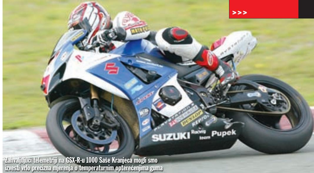
Zahvaljujući telemetriji na GSX-R-u 1000 Saše Kranjeca mogli smo izvesti vrlo precizna mjerena o temperaturnim opterećenjima guma
