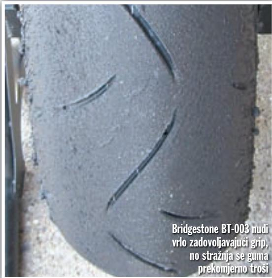
Bridgestone BT-003 nudi vrlo zadovoljavajući grip, no stražnja se guma prekomjerno troši
