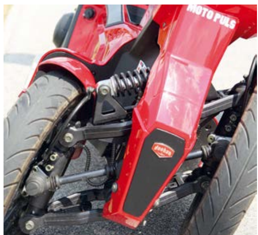
Izvedba prednjeg ovjesa je iznenađujuće jednostavna, ali istovremeno i učinkovita. Problem nastaje tek kad naletite na veće neravnine
