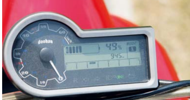
Na ploči s instrumentima vidite koliko ampera u svakom trenutku trošite, ali i koliko ih proizvodite kod regenerativnog kočenja
